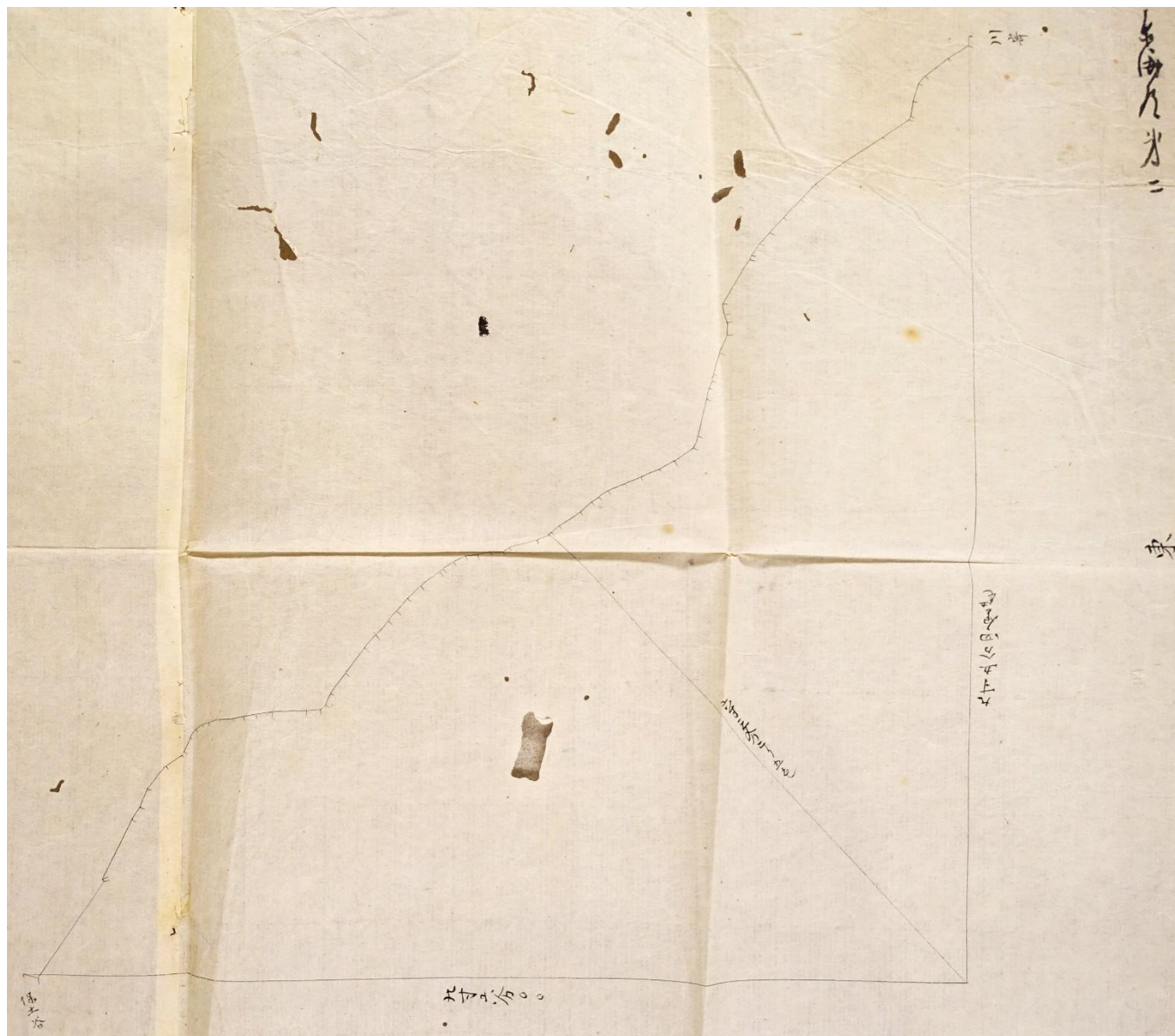
「自武蔵国橋樹郡川崎宿至武蔵国橋樹郡保土ヶ谷宿下図」の測線部分、右下は墨書部分 伊能忠敬記念館所蔵 無断流用禁止
