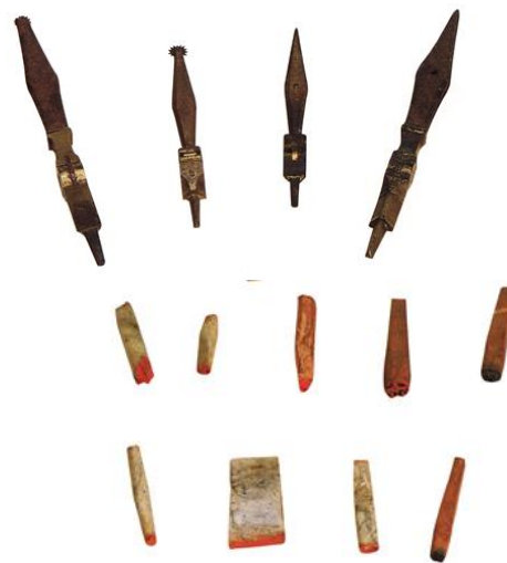
点線器(上左) 烏口(上右) 合印(下) 千葉県香取市伊能忠敬記念館所蔵
